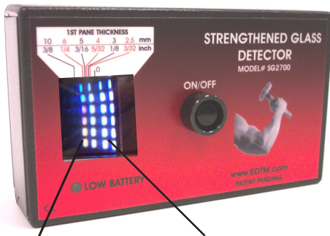
Figura 1: SG2700 examinando una ventana de doble vidrio. Observe que una columna de la reflexión ocurre para cada superficie de cristal.
